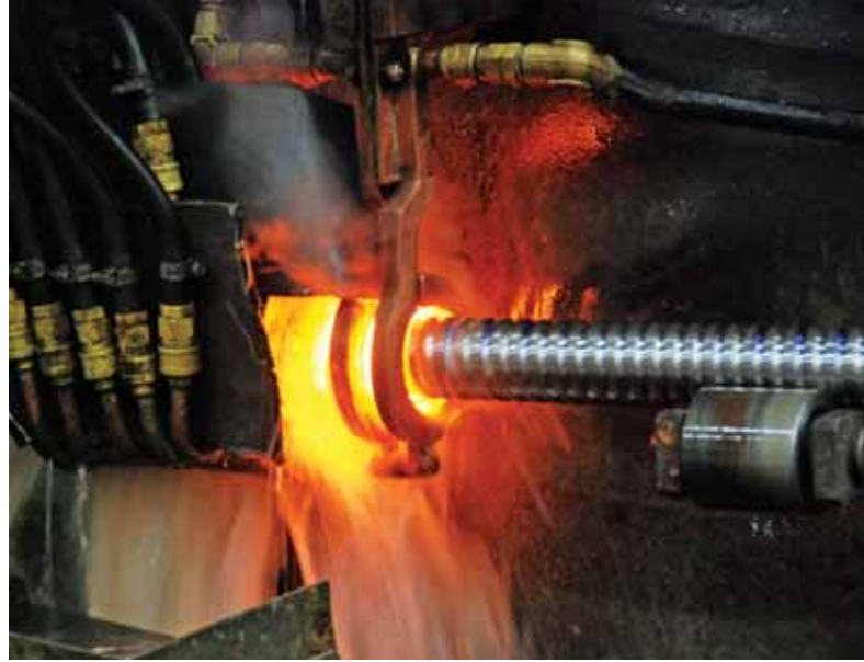
Trattamento termico ad induzione
