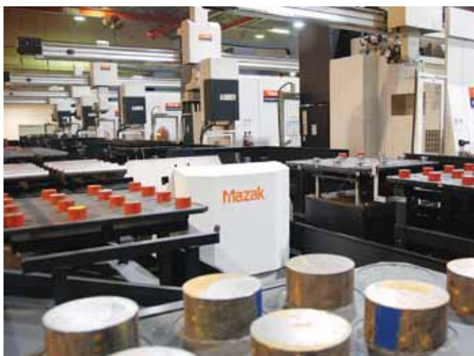
Linea Palletech con Integrex e sistema di caricamento ad assi cartesiani
